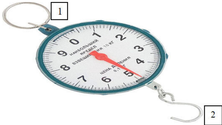
Рисунок 38. Пружинный динамометр. 1- кольцо для фиксации прибора; 2- кольцо для завязывания шва
